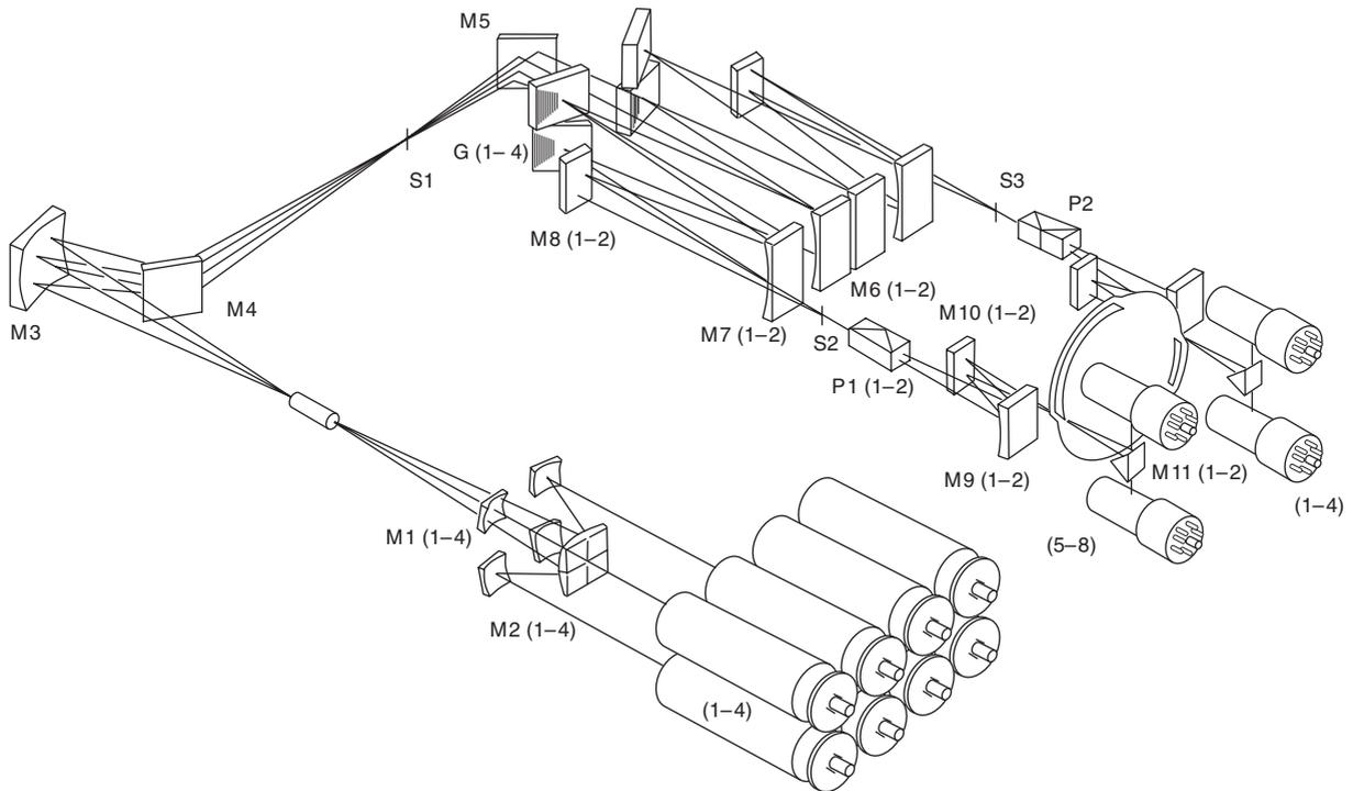
4.35 Frühes Multielement-AAS-Gerät nach dem Prinzip des Mehrfachaufbaus.
